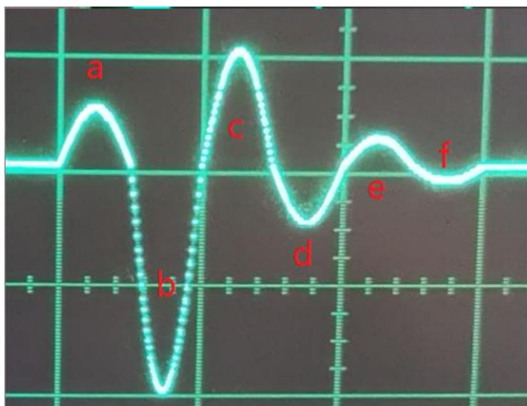
波形 a 幅度=设置波形幅度/8 波形宽度=设置波形周期/2
