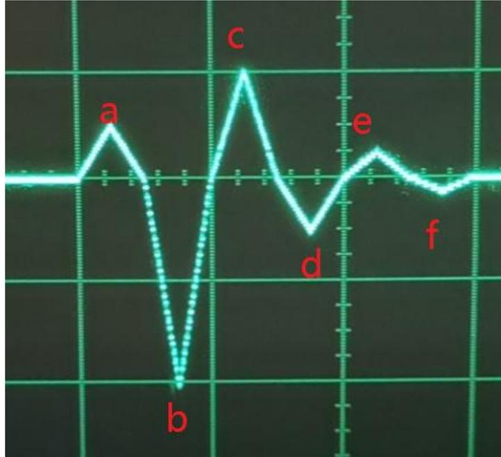
波形 a 幅度=设置波形幅度/8 波形宽度=设置波形周期/2
