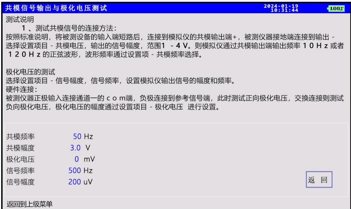
**共模频率：**设置共模信号输出时的信号频率，20Hz-200Hz，步长10Hz。
