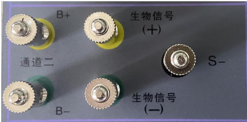
在软件通道二的窗口设置中，设置波形的类型，频率及幅度后，模拟仪将通过通道二的输出端子输出信号，幅度对应如下
