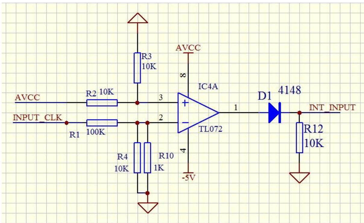
INPUT\_CLK 为刺激输入端，其电平范围为直流电压 100-500V 之内，脉冲宽度 > 10 $\mu$ s。通过调整 电阻 R3 的阻值，来对输入端 INPUT\_CLK 的电压进行比较后输出触发信号到 CPU。
